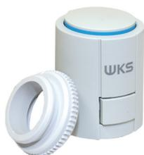
Thermoelektrischer Stellantrieb zur Betätigung von Ventilen am Heizkreisverteiler von FB-HZG. Mit First-Open-Funktion für einfache Montage und Inbetriebnahme, incl. Ventiladapter VA 80, stromlos geschlossen, nur 1 Watt Leistungsaufnahme, max. 5 Stellantriebe auf 1 Raumthermostat anzuschließen.
