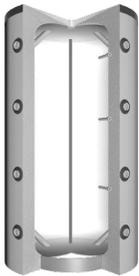
**JPSH Hochleistungs-Pufferspeicher mit Hoher Bauart, ohne Wärmetauscher, mit 8x Muffen 2" für hohe Volumenströme sowie 4 Gehrungsrohren DN 50, 3x Muffe 1/2" für Fühler / Thermometer.**
