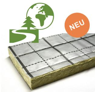
Verlegefertige Wärme- und Trittschalldämmplatte für Gebäude aus druckfester, nicht brennbarer Mineralwolle nach DIN EN 13162, als Verbundplatte mit einer reißfesten und wasserdichten Verbundfolie nach DIN 18560 und DIN EN 1264 mit aufgedrucktem Verlegeraster VA 50 mm und Vielfache und zweiseitiger Folienüberlappung zur Erstellung einer normgerechten Flächenheizung der Bauart A unter Estrichmörteln/-massen auf Dämmschichten.
