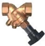
Strangregulierventil aus Rotguss, Einbau in Vor- und Rücklauf möglich, beiderseits Innengewinde, auch für Grundwasserleitung als Regulier-Drosselventil einsetzbar.
