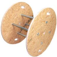
Zum vertikalen Abrollen von 600 m Rollen in Verbindung mit der vorstehenden Abrollvorrichtung für Einwegtrommel. Anleitung: 4 Hutmuttern lösen, Seitenteil abnehmen, Rohr-Rolle aufbringen, Seitenteil wieder anschrauben und los geht's.
