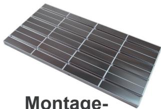
Trockenbauelemente aus einer formgeschäumten Polystyrolplatte aus EPS Neopor 032 DEO nach DIN EN 13163 und DIN 4108-10. Aufgeklebtes Aluminiumblech 0,5 mm stark. Sichere Rohrbefestigung mittels profilierten Omegarillen. Die Elemente der Bauart B nach DIN 18560 und DIN EN 1264 können mit Nassestrich oder mit Fertigteilestrichen belegt werden und ist auch als Wandkonstruktion geeignet.
