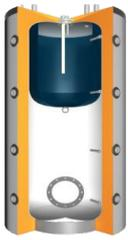
**JHKE/F Kombi-Speicher**, ohne Wärmetauscher, mit Flansch, Heizwasser-Pufferspeicher mit integriertem Warmwasserbereiter, **inkl. Muffe für E-Stab 1 1/2"**, Betriebsdruck 3/6 bar, **kommunizierend**, 1 Stück eingebaute Magnesiumanode 5/4", inkl. Fühlerklemmleiste zur variablen Positionierung der Fühler.
