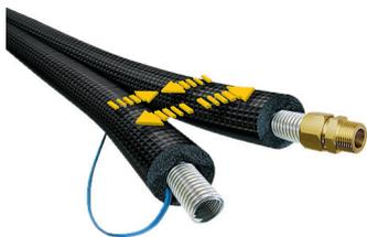
Armaflex DuoSolar ist ein flexibles, vorisoliertes und UV-beständiges Dämmsystem zum einfachen und fachgerechten Anschluss von Solarkollektoren an den Warmwasser-Speichertank. Das System bietet ein intelligentes „Join-Split“-Verbindungssystem mit zwei Kupfer- oder Edelstahlschläuchen sowie eine integrierte Fühlerleitung.
