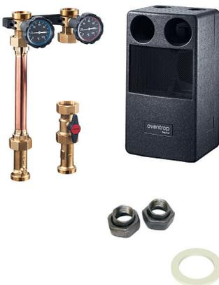
„Regumat S-180“ mit Pumpenkugelhahn und Universalwärmedämmung. Beim Stromanschluß von Hocheffizienzpumpen ist kein Winkelstecker mehr erforderlich. Es können handelsübliche Pumpen (DN 25, Baulänge 180 mm, 1½" AG) eingebaut werden.
