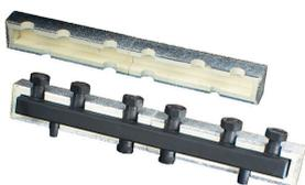
Anschluss zum Heizkreis mit IG 1½" ÜM, flachdichtend, Anschluss zum Kessel 1½" AG, flachdichtend, inklusive Wandhalterung für Regumat mit Achsabstand 125 mm und Isolierung. Durchfluss bis max. 4 m³/h, aus Stahl.
