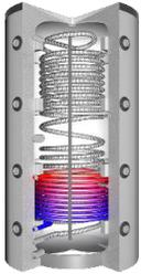
**EHSWP Hygiene-Schichtenkombispeicher - Hochleistung bzw. für Wärmepumpen**, Heizungspufferspeicher (3 bar) mit **Glattrohrwärmetauscher**, innen roh, Trinkwassererwärmung im Durchlaufprinzip, hygienisch, Legionellen freie Warmwasseraufbereitung mit **sehr** hoher Zapfleistung (Edelstahlwellrohr V4A 1.4404, 6 bar), inkl. Fühlerklemmleiste zur variablen Positionierung der Fühler.
