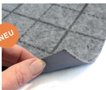
Das WKS-Tempus-Flat-Klett-Systemelement besteht aus einer nur 2 mm dünnen Kunstfaser-Deckschicht mit einer hohen Klettwirkung. Der vollflächig auf der Rückseite aufgebraute Kleber ermöglicht die Fixierung auf ebenen Flächen ohne weitere Hilfsmittel. (Untergründe gemäß DIN 18202 mit erhöhter Anforderung).
