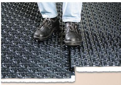
Mit Wärme- und Trittschalldämmung Anwendung nach DIN EN 13163 für Innendämmung auf Decken oder Bodenplatten unter Estrichen nach DIN V 4108-10. Aus PS-Folie mit trittfest ausgeformten Rohrhaltennoppen zur sicheren Rohrfixierung bei 90° achsialer und 45° diagonaler Verlegung mit zweiseitigem Folienüberstand für estrichdichte Druckknopfverbindung, für Heizrohre 14 mm.
