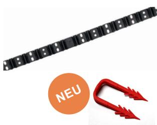
Selbstklebende Rohr-Klemmschiene zur Befestigung von Heizrohren auf Dämmung oder Wand, Verlegeabstand alle 5 cm möglich. Bedarf ca. 2 m Schiene pro m<sup>2</sup> Wandheizung.
