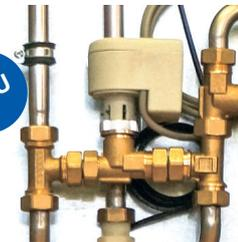
WW-Vorrangschaltung: Besteht aus einem 3-Wege-Umschaltventil DN20 mit 230V Stellmotor und einem elektrischen Durchflussschalter. Vorverkabelt mit Dose.
