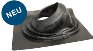
Universell einsetzbar, für Anschlüsse von Rohrdurchdringungen an Unterdeckbahnen und an Luftsperrern. Einfach über das Rohr ziehen, mit dem Untergrund verkleben und fertig.
