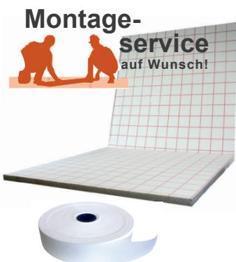
WKS-Klett-Faltplatte als Rohrträger in geklappter Ausführung mit Wärme- und Trittschalldämmung mit aufkaschierter Gewebe-Haftfolie zur überlappenden Verlegung mit einseitigem Folienüberstand zur Abdeckung der Dämmschicht.
