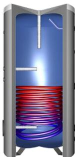
**HRSS-Brauchwasserspeicher emailiert nach DIN**, mit **einem** Wärmetauscher, 2 Stück Magnesiumanode 5/4" (bereits eingebaut) (ab Typ 3000 - 3 Stück), Betriebsdruck 10 bar, WT 10 bar, Flansch 180mm.
