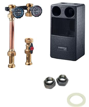
„Regumat S-180“ mit Pumpenkugelhahn und Universalwärmedämmung. Beim Stromanschluß von Hocheffizienzpumpen ist kein Winkelstecker mehr erforderlich. Es können handelsübliche Pumpen (DN 25, Baulänge 180 mm, 1½" AG) eingebaut werden.
