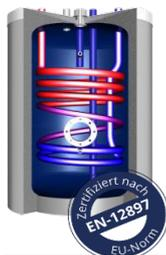
**EHRE-Hochleistungsunterstellspeicher** emailliert, 50mm PUR-Hartschaum-Isolierung direkt geschäumt mit Skymantel, Thermometer, Magnesiumanode, Farbe silber, Anschlüsse oben am Speicher, Betriebsdruck 10 bar, Wärmetauscher Betriebsdruck 16 bar. Flansch 180mm
