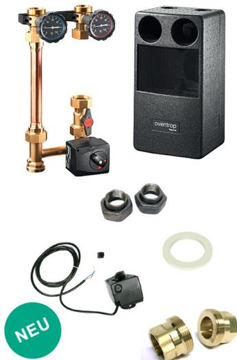
„Regumat M3-180“ mit Pumpenkugelhahn und Universalwärmedämmung. Beim Stromanschluß von Hocheffizienzpumpen ist kein Winkelstecker mehr erforderlich. Es können handelsübliche Pumpen mit Baulänge 180 mm eingebaut werden. Der Stellantrieb ist ohne Werkzeug montierbar „Plug&Play“-Prinzip. **Technische Daten:** Achsabstand: 125 mm
