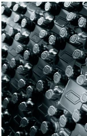
Mit Wärme- und Trittschalldämmung Anwendung nach DIN EN 13163 für Innendämmung auf Decken oder Bodenplatten unter Estrichen nach DIN V 4108-10. Aus PS-Folie mit trittfest ausgeformten Rohrhaltennoppen zur sicheren Rohrfixierung bei 90° achsialer und 45° diagonaler Verlegung mit zweiseitigem Folienüberstand für estrichdichte Druckknopfverbindung, für Heizrohre 14 mm.
