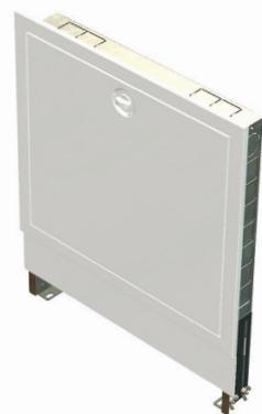
Verteilerschrank Typ UNI 80 T mit höhenverstellbarer Einbauzarge aus feuerverzinktem Stahlblech. Verstellbarer und abnehmbarer Rahmen mit Stecktüre aus Galvanisch verzinktem Stahlblech, pulverbeschichtet RAL 9016. Mit Drehriegelverschluß aus Kunststoff.
