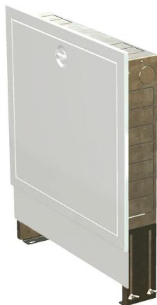
Verteilerschrank Typ UNI 110 T mit höhenverstellbarer Einbauzarge aus feuerverzinktem Stahlblech. Verstellbarer und abnehmbarer Rahmen mit Stecktüre aus Galvanisch verzinktem Stahlblech, pulverbeschichtet RAL 9016. Mit Drehriegelverschluß aus Kunststoff.
