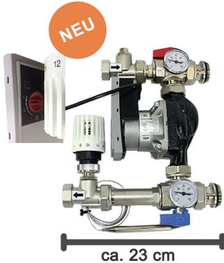
Für Fußbodenheizung am Heizkörperstrang, mit Festwert-Regelkopf 10-50°C, Anschluß 1" am Verteiler, Regulier- und Absperrventil DN 20, mit Hocheffizienzpumpe, Sicherheitstemperaturbegrenzer unveränderbar auf 55°C fest eingestellt, 2 Thermometer.
