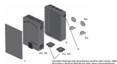
Variable Montage der Abzweige nach oben oder unten, ÜB4/ Abzweige: Standard Ø100 mit oder ohne Lippendichtung.
