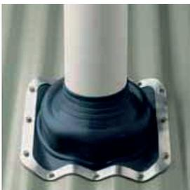
Ideal für die Abdichtung von Rohren auf Metalldächern. Die Dektite® Rohrmanschette ermöglicht eine perfekte Abdichtung von Rohrdurchführungen an Dach und Fassade. Das Montageset besteht aus der Dektite® Rohrmanschette, Bohrschrauben und einem geeigneten Dichtmittel. Das Set ist komplett vorgerichtet für die Montage.
