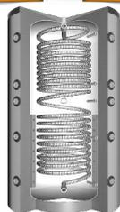
**EH Hygiene-Schichtenkombispeicher**, Heizungspufferspeicher (3 bar) **ohne** Glattröhrwärmetauscher, innen roh, hygienisch, legionellenfreie Wasseraufbereitung mit hoher Zapfleistung, Trinkwassererwärmung im Durchlaufprinzip (Edelstahlwellrohr V4A 1.4404, 6 bar), inkl. Fühlerklemmleiste zur variablen Positionierung der Fühler, **kommunizierend. inkl. Muffe für E-Stab 1 1/2"**
