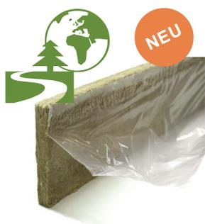
Randstreifen aus 13 mm nicht brennbarer Steinwolle WLG 035 mit aufgenähtem PE Folienflansch, zur Vermeidung von Schallbrücken zwischen schwimmenden Estrich und aufgehenden Bauteilen, sowie Schutz der Dämmung gegen Estrichanmachwasser im Randbereich gemäß DIN 18560. Länge 1000 mm.
