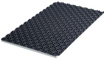
WKS-Noppenplatte DS bestehend aus einer EPSTiefziehfolie mit zweiseitiger Überlappung zur Aufnahme der Heizrohre in den Dimensionen 10 mm bis 12 mm mit unterseitiger vollflächiger Klebeschicht, Oberfläche gelocht, geschützt durch Trennfolie.
