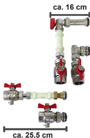
Für Wärmemengenzähler bis Qn 1,5mm und 110mm Baulänge. Vor- und Rücklauf mit Kugelhähne 1" und jeweils Tauchfühleranschluss M 10 x 1 mm. Zähler - Passstück 110 mm im Rücklauf.
