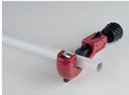
Das Metall-Kunststoff-Verbundrohr mit Rohr-Schneider/ Schere rechtwinklig ablängen. Bei Rohren mit einer Klettummantelung, ist diese Ummantelung soweit vom Rohr abzutrennen, dass die Montage der Fittinge problemlos durchgeführt werden kann. Ca. 5 cm vom Rohrende
