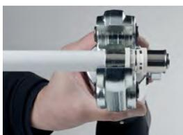
Pressvorgang mit einer TH-Kontur: Das Presswerkzeug ansetzen und den Kunststoffring der Edelstahlhülse in die Führung der Pressbacke einlegen. Danach den Pressvorgang (je nach Maschinentyp) auslösen. Der Pressvorgang ist beendet, wenn der vollständige Pressbackenschluss erreicht ist. Es müssen 2 breite Rillen auf der Edelstahlhülse gleichmäßig umlaufend sichtbar sein.
