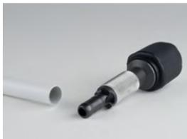
Das zur Rohrdimension passende Entgrater- und Kalibrierwerkzeug auswählen, vollständig in das Rohr einschieben und dabei im Uhrzeigersinn drehen. So wird das Rohrende in einem Arbeitsgang kalibriert und angefast. Anfallende Späne nach Beendigung des Arbeitsgangs aus dem Rohrende entfernen.
