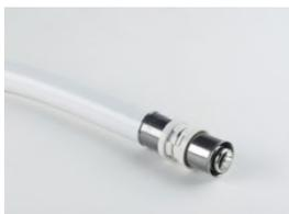
Die Rohrbiegungen dürfen nicht unmittelbar hinter dem Pressfitting beginnen. Hier muss eine gerade Strecke von mindestens 1 x Rohraußendurchmesser vorgesehen werden.
