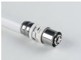
Das Metall-Kunststoff-Verbundrohr mit wenig Kraftaufwand bis zum Anschlag in den Pressfitting einschieben. Das Rohr ist in allen Sichtfenstern vollflächig zu sehen. Bei Pressfittingen  $\geq 40$  mm zunächst die Presshülse auf das Rohr schieben und danach das Rohr mit der Presshülse bis zum Anschlag auf die Stützhülse schieben.
