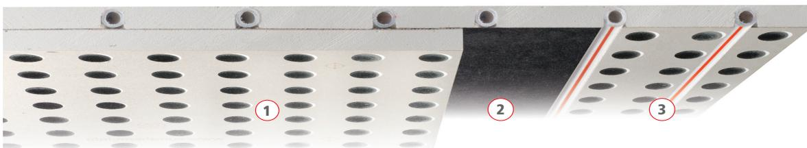
Die Akustikdecken bestehen aus jeweils zwei miteinander verklebten gelochten Gipskartonplatten, bei denen das Lochmuster exakt übereinander angeordnet ist. Rückseitig ist ein schwarzes Akustikvlies vollflächig aufkaschiert. In der oberen Lochplatte sind werkseitig integrierte Rohre 10x1,3 mm. Für eine optisch einheitliche Deckenuntersicht sind für inaktive Bereiche auch thermisch inaktive Deckenelemente verfügbar.
