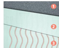
1. Dämmplatte aus EPS + Graphit.
