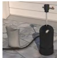
Entfernen Sie den Ablauf- und Spülschlauch, schrauben Sie den Spülkopf ab und leeren den Behälter in den Filtersack.
