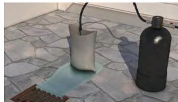
Spülen Sie solange, bis wieder klares Wasser aus dem Spülschlauch kommt. Schließen Sie den Kugelhahn und die Wasserzufuhr.
