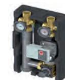
3-Weg-Weichenventil 1" mit Volldurchgang, mit Motor; zur vorrangigen Aufladung des oberen Speicherbereiches bei WP-Anlagen ohne HGL-Technik
