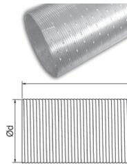
aus zweilagigem Aluminiumband, an den Überlappungsstellen dreilagig verrillt. Entspricht den Anforderungen nach DIN 24146 und ist nicht brennbar gemäß DIN 4101 Klasse A1.
