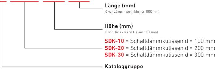
Die Längen L sind **NUR** mit den angeführten Abmessungen lieferbar. Größere Höhen h und Längen L lassen sich durch Zusammenbau mehrerer Kulissen erreichen.
