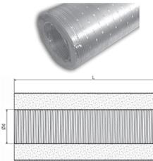
Innen und außen ein normales Aluflex-Rohr mit dazwischen liegender Isolierschicht (25 mm) aus nicht brennbarer Glasfaser. Der Biegeradius beträgt je nach Außendurchmesser 1-1,5 x d2.
