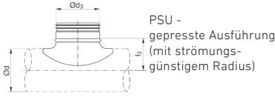
PSU - gepresste Ausführung (mit strömungsgünstigem Radius)
