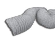
Hochflexibler Lüftungsschlauch aus einem robusten Gewebe mit PVC-Beschichtung und eingelegter Stahldrahtverstärkung. Standardfarbe: grau. In Netze verpackt. Ein Auseinanderziehen auf die ursprüngliche Fertigungslänge ist problemlos möglich. Max. Betriebsdruck (Überdruck): 2.500 Pa; Max. Luftgeschwindigkeit: 30 m/s
