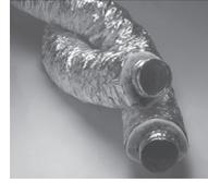
Innenschlauch aus mehrer Schichten Aluminium und Polyester. Außenmantel aus aluminisierten Polyester. In Kartons gepresst. Max. Betriebsdruck (Überdruck): 2.500 Pa; Max. Luftgeschwindigkeit: 20 m/s
