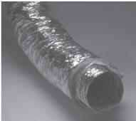
„mikroperforierter“ Innenschlauch (umgeschlossen von einer absolut diffusions- und staubdichten Schicht), 25 mm Isolierung und Außenmantel aus einer mehrlagig verleimten Aluminium-/ Polyester-Folie. In Kartons gepresst. Max. Betriebsdruck (Überdruck): 1.800 Pa; Max. Luftgeschwindigkeit: 30 m/s
