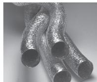
Hochflexibler polyesterverleimter Aluminium-Lüftungsschlauch mit eingelegter Stahldrahtverstärkung (Abstand 24 mm). nach DIN 4102-A2. In Kartons gepresst. Ein Auseinanderziehen auf die ursprüngliche Fertigungslänge ist problemlos möglich. Max. Betriebsdruck (Überdruck): 2.000 Pa; Max. Luftgeschwindigkeit: 30 m/s
