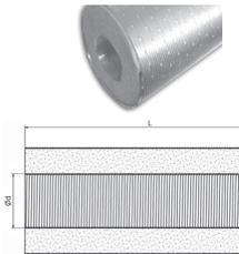
Innen und außen ein normales Aluflex-Rohr mit dazwischen liegender Isolierschicht (50 mm) aus nicht brennbarer Glasfaser. Der Biegeradius beträgt je nach Außendurchmesser 1-1,5 x d2.
