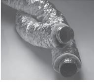
Innenschlauch auf Basis des Aluschlauches MO, 25 mm Isolierung und einem Außenmantel aus einer mehrlagig verleimten Aluminium-/ Polyester-Folie. Absolut dampfdicht. In Kartons gepresst. Max. Betriebsdruck (Überdruck): 2.500 Pa; Max. Luftgeschwindigkeit: 30 m/s
