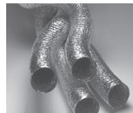
Hochflexibler polyesterverleimter Aluminium-Lüftungsschlauch mit eingelegter Stahldrahtverstärkung (Abstand 24 mm). nach DIN 4102-A2. In Kartons gepresst. Ein Auseinanderziehen auf die ursprüngliche Fertigungslänge ist problemlos möglich. Max. Betriebsdruck (Überdruck): 2.800 Pa; Max. Luftgeschwindigkeit: 30 m/s
