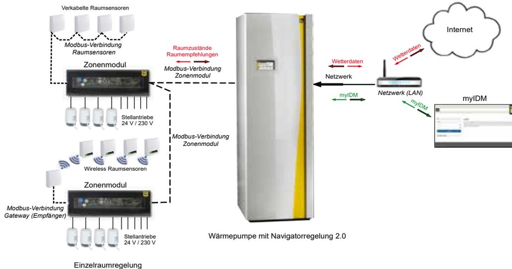
Die Regelung der einzelnen Fußbodenkreise erfolgt über die iDM-Zonenmodule und die iDM-Raumsensoren.
