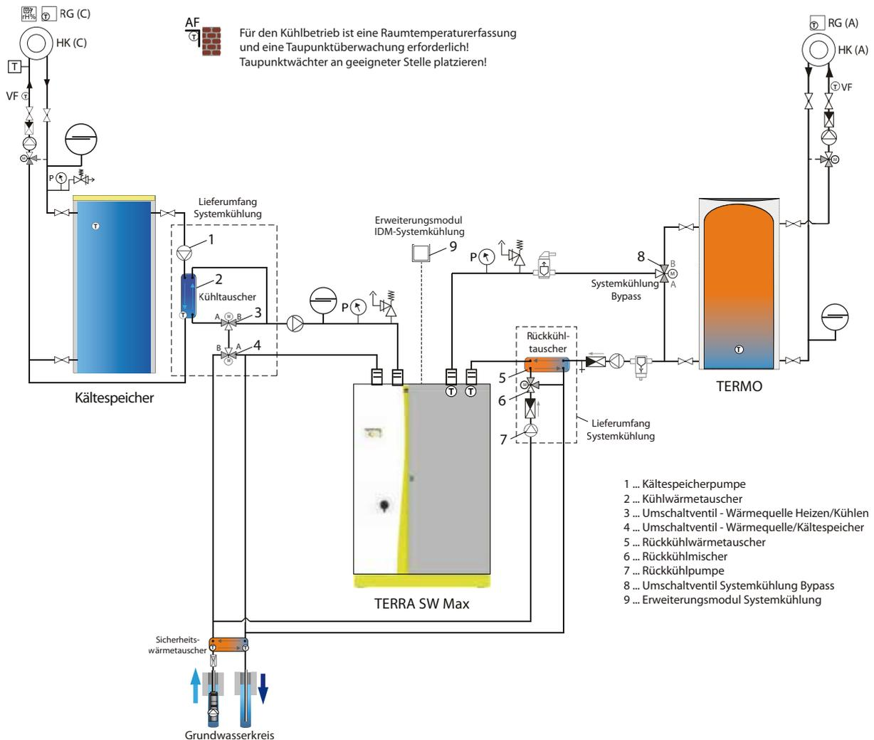
Abb.: Beispiel für iDM Systemkühlung (Sole oder Grundwasser möglich)
