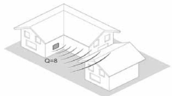
Eine Verdopplung des Abstandes bedeutet eine Abnahme des Schalldruckpegels von 6 dB(A)!
