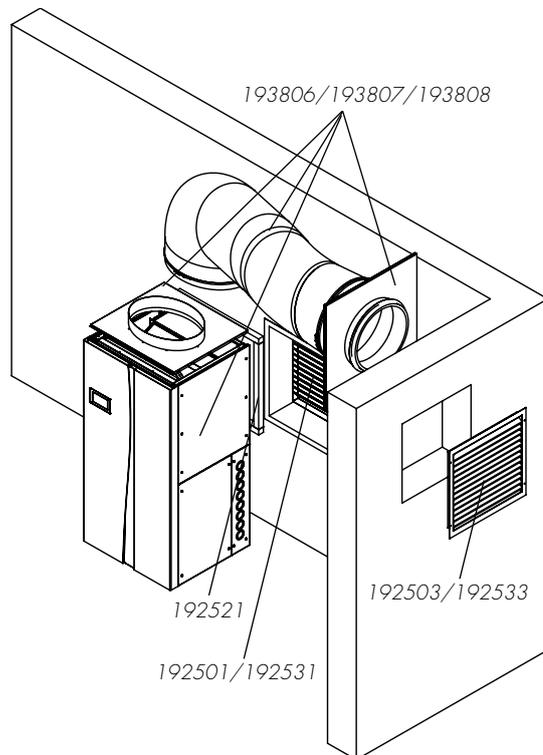
**! Luftausblas kann nach links, nach rechts oder nach oben ausgeführt werden.**
