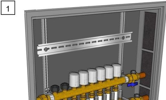
Eine Hutschiene aufputz oder im Heizkreisverteilerschrank montieren oder eine vorhandene nutzen.
