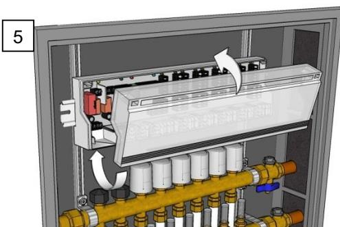
Den Deckel schließen und die Netzspannung herstellen. Die Basis ist jetzt einsatzbereit.
