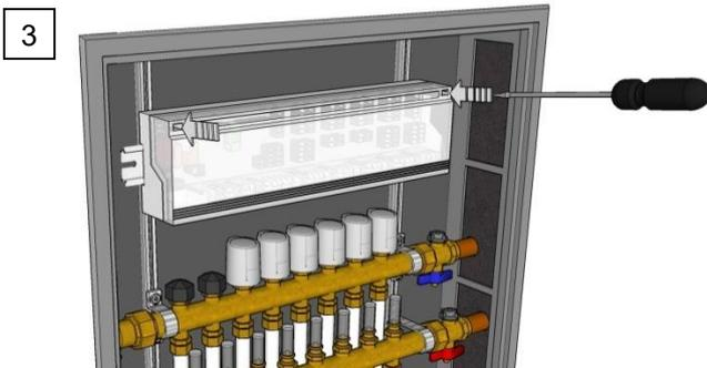
Die Gehäuseabdeckung an den beiden Verriegelungspunkten mit einem Schraubendreher lösen und abnehmen.
