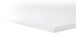
**Dämmplatte aus extrudiertem Polystyrol XPS**, ausgewiesene Wärmeleitfähigkeit  $\lambda_D$  von 0,033 W/m-K (UNI EN 13164, UNI EN 12667); Druckfestigkeit bei 10 % Stauchung: 300 kPa (DIN EN 826); Brandverhalten: Euroklasse E (DIN EN 13501-1).
